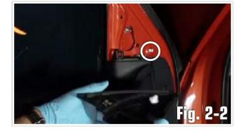
2. Disengage door locking tab. (Fig. 2-3)
